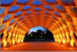
diesem Projekt, das einen pittoresken, im 19. Jahrhundert angelegten Teich in ein ökologisches Reservat verwandelt. Sie sollen in wärmeren Jahreszeiten auch als Klassenzimmer verwendet werden. Die Struktur der Pavillons besteht aus laminierte Holz-Leimbindern. Sie sind so geformt, dass sie Art Geflecht bilden. (architektur+technik 2011)
