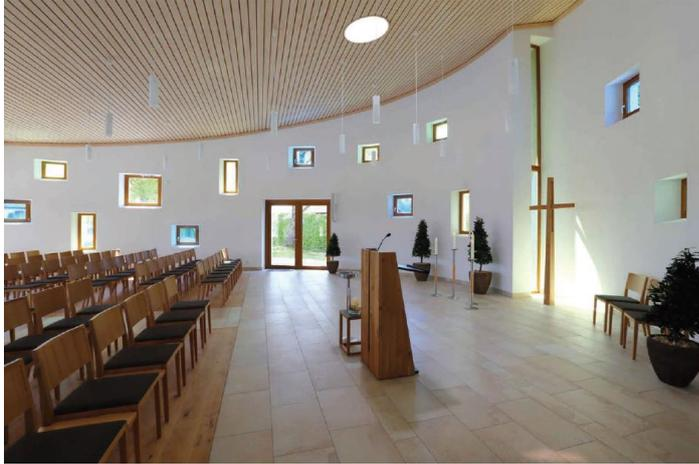
BU: Die edlen Echtholzoberflächen der über mehr als 12 m frei gespannten Lignotrend Dachelemente LIGNO Akustik Q3 klassik BV unterstützen den beruhigenden Charakter der Innenraumgestaltung. Bereits bei Einbau sorgen sie für eine angenehme Akustik in dem 220 qm großen Raum.
