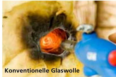
**Bild 2:** Die Hitze der Flamme lässt die Glasfasern schmelzen, ein glühender Tunnel entsteht. Ein Feuer könnte sich nahezu ungehindert weiter ausbreiten.
