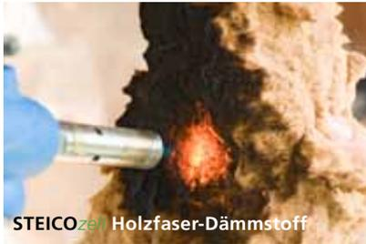
**Bild 1:** Die Flamme des Bunsenbrenners erzeugt eine Verkohlungs-schicht an der Oberseite, die ein schnelles Durchbrennen verhindert. Der Dämmstoff lässt sich sicher in der Hand halten.
