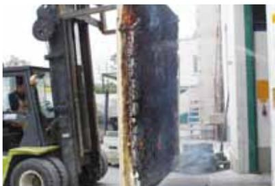
**Bild 3:** Test bestanden - Die Konstruktion wird aus dem Prüfstand gehoben. Gut zu erkennen ist die Verkohlungsschicht auf der Oberseite, wodurch die Ausbreitung des Feuers gehemmt wird.
