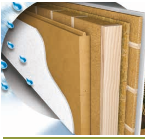
Aussenwand: verputzbare Fassadendämmung im Holzrahmenbau.
