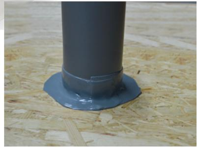
Für dauerhaft luftdichtes Abdichten von Durchdringungen in unterschiedlichen Größen, Formen und Materialien. Das einseitig klebende Butylkautschukband ist 300% dehnbar. Die extrem hohe Klebkraft erlaubt auf verschiedensten Untergründen meist ein Arbeiten ohne Primer. Auch die Finger bleiben durch die Folienoberfläche sauber.
