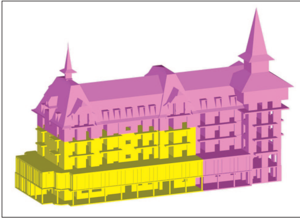
Modellierung der im Jahre 1906 vorgenommenen Erweiterung vom dreigeschossigen (gelb) zum sechsgeschossigen (magenta) «Kurhaus Nünalphorn» (rechts).
