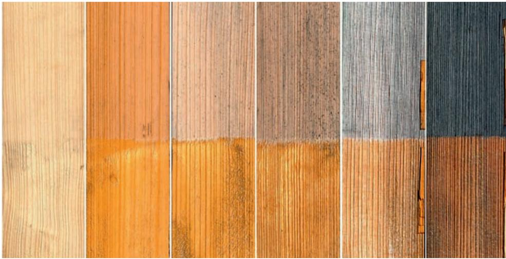
**Abb. 1:** Farbveränderung bei unbehandelter Fichte im Verlauf von 0–52 Wochen Bewitterung Richtung Süd unter 45° Neigung (oberer Bereich); der untere Bereich wurde mittels Dampfdruck gereinigt; bei den beiden rechten Proben erfolgte eine anschließende künstliche Wiederbewitterung.
