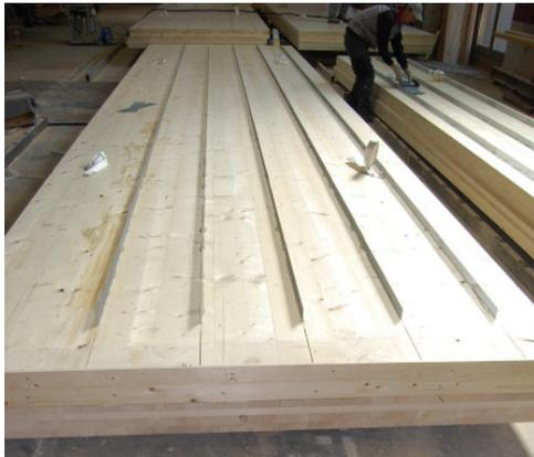
Brettsperrholzelemente mit HBV®-Schubverbindern
