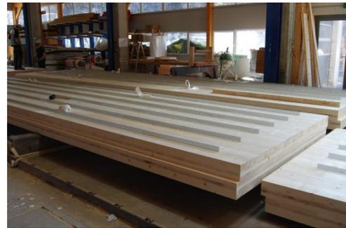
Brettsperrholzelemente mit HBV®-Schubverbindern
