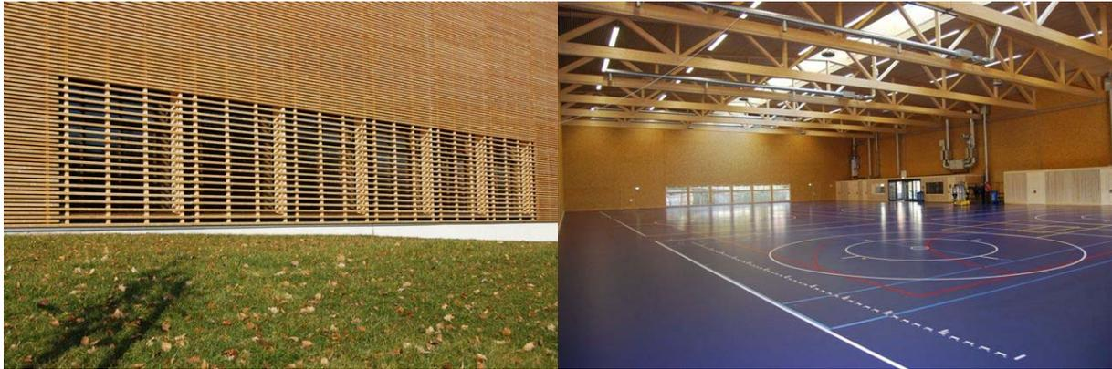
Dank der geschickten Anordnung der in die Giebfassaden integrierten Fensterbänder (links) sowie des im First durchgängig angeordneten Oblichtes gelangt erstaunlich viel Tageslicht ins Halleninnere (rechts).
